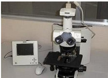
個々のアスベストが特異的に持つ分散特性（光の波長による屈折率の違い）を利用し、鮮明なアスベストの分散染色観察（定性検査）が可能です。
